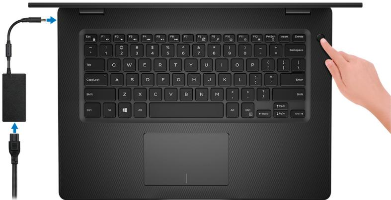
**CATATAN:** Untuk menghemat daya baterai, baterai dapat masuk ke mode hemat daya. Sambungkan adaptor daya dan tekan tombol daya untuk menyalakan komputer.
