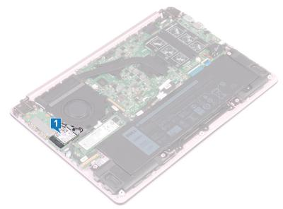
2 ワイヤレスカードブラケットを I/O ボードに固定しているネジ (M2x5)を外します。
