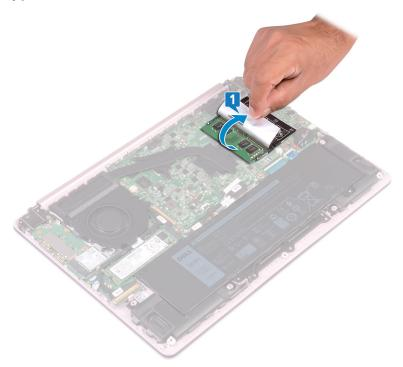
**2** メモリモジュールスロットの両端にある固定クリップを、メモリモジュールが持ち上がるまで指 先で慎重に広げます。 メモリモジュールをメモリモジュールスロットから取り外します。
