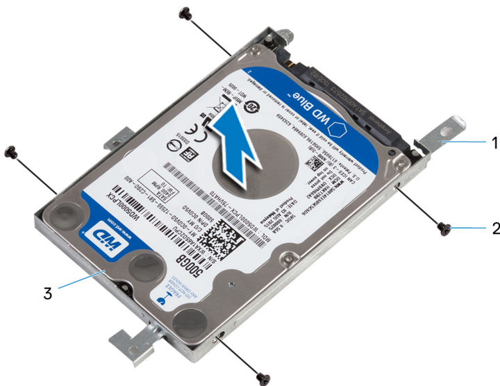
Рисунок 18. Извлечение жесткого диска
