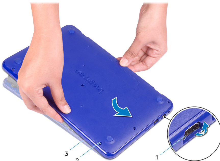
Рисунок 5. Снятие нижней крышки
