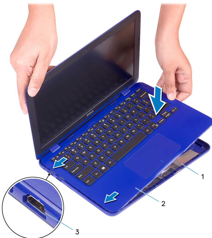
Рисунок 8. Установка нижней крышки
