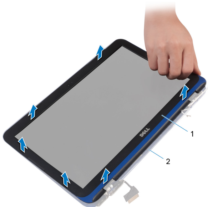
Рисунок 33. Снятие лицевой панели дисплея
