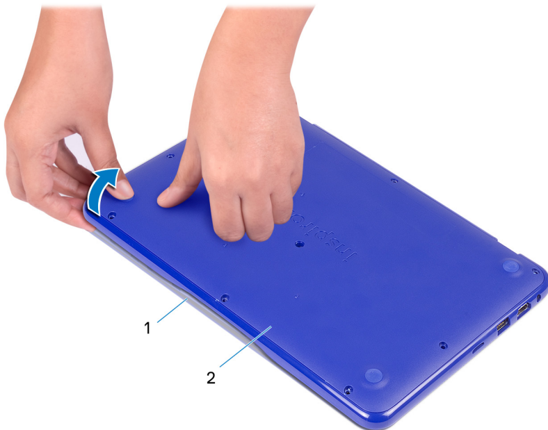
Рисунок 3. Снятие нижней крышки
