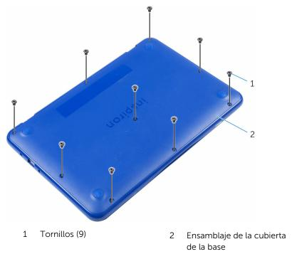
4 Haga palanca en el lado izquierdo del ensamblaje de la cubierta de la base para soltarlo del ensamblaje del teclado y del reposamanos.
