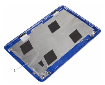
1 ensamblaje de la antena y la cubierta posterior de la pantalla
