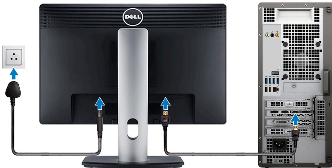
**ПРИМЕЧАНИЕ:** Если вы заказали компьютер с отдельной видеокартой, порты HDMI и Display Port на задней панели компьютера будут закрыты. Подключайте дисплей к выделенному графическому адаптеру.
