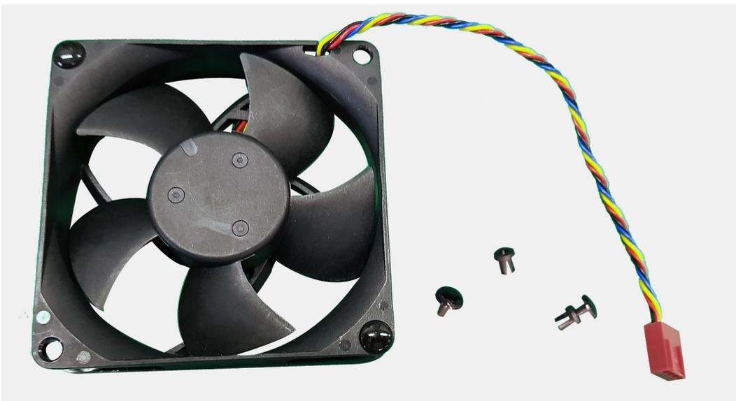
2. Faites passer les tiges en caoutchouc dans les trous du ventilateur et tirez sur les tiges jusqu'à ce que le ventilateur s'enclenche.
