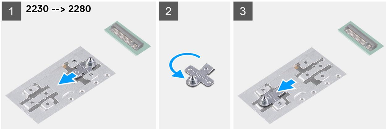
En la siguiente imagen, se proporciona una representación visual del procedimiento para instalar el soporte de montaje para unidad de estado sólido cuando se reemplaza una unidad de estado sólido M.2 2280 con una unidad de estado sólido M.2 2230 en la ranura de SSD2.
