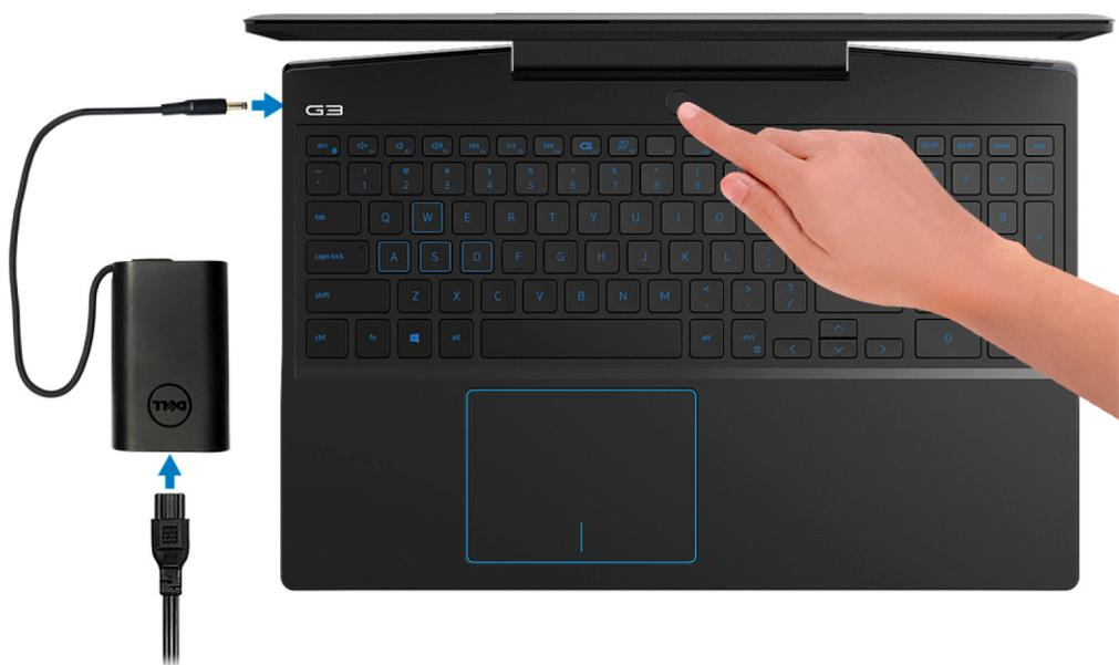
**NOTA:** Para conservar la energía de la batería, es posible que esta entre en el modo de ahorro de energía. Para encender el equipo, conecte el adaptador de alimentación y presione el botón de encendido.
