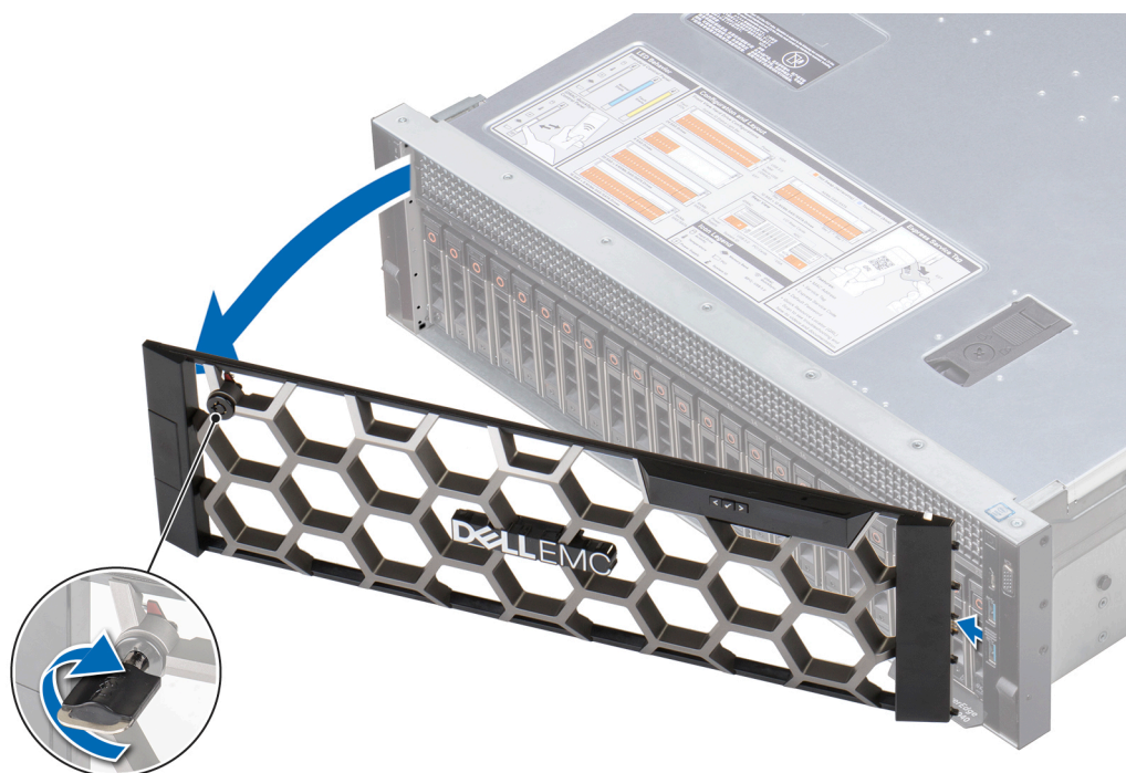
图 13: 卸下可选的前挡板与 LCD 面板
