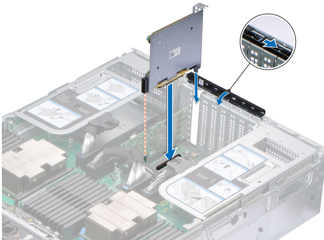
图 45: 安装 NDC 提升板
