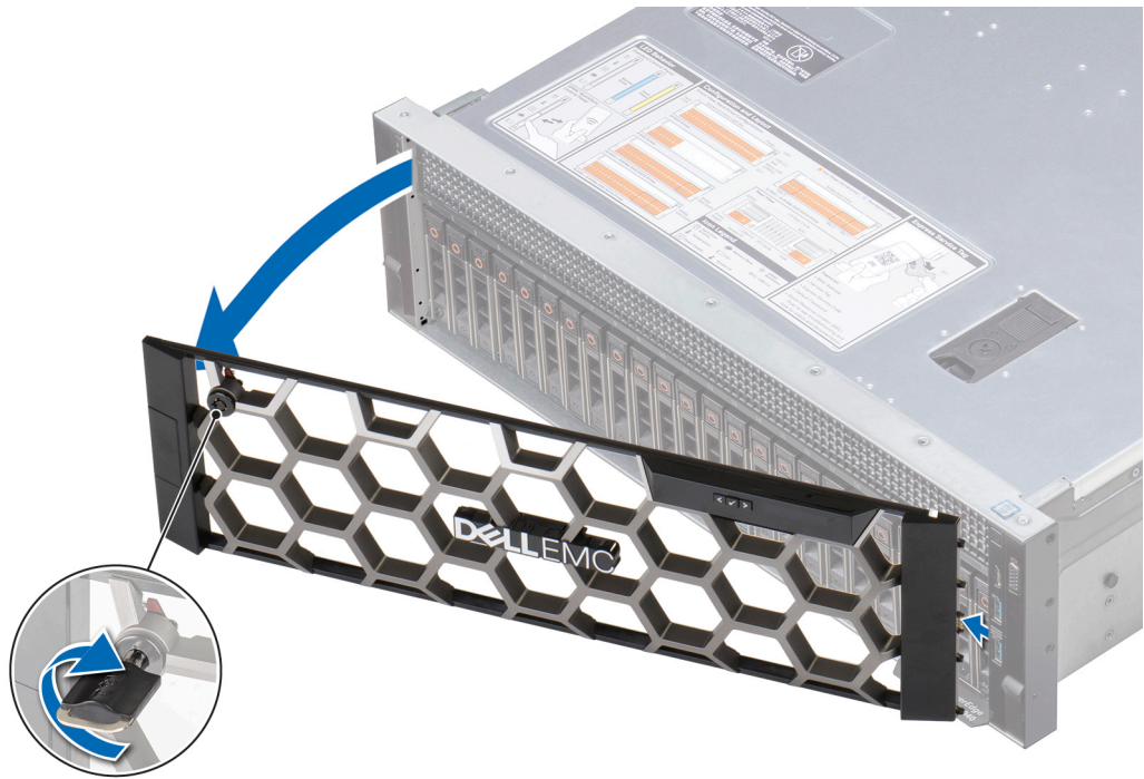
그림 13. LCD 패널을 포함하는 전면 베젤(선택 사항) 제거
