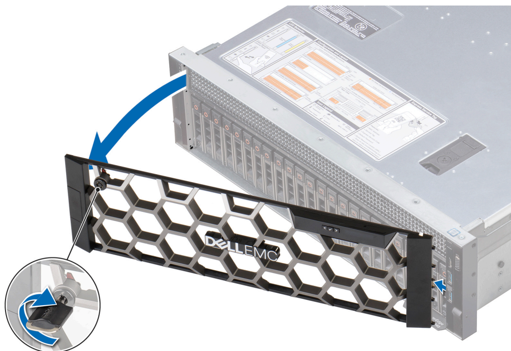
図 13. オプションの LCD パネル付き前面ベゼルの取り外し
