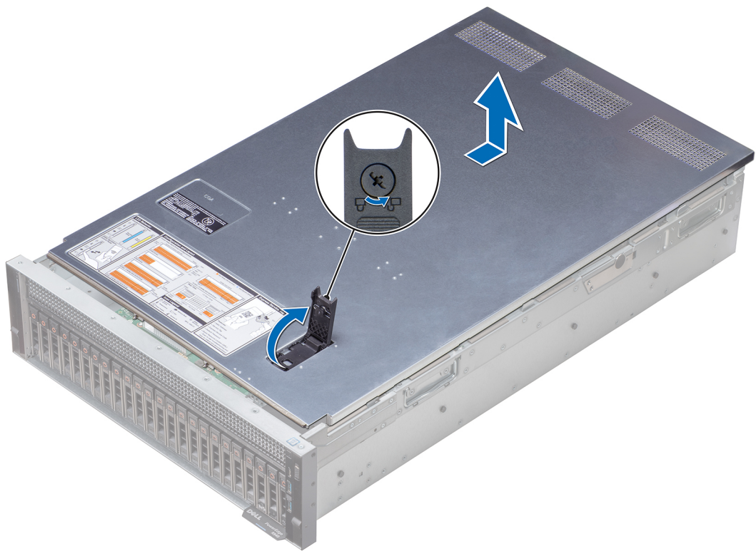
図 15. システムカバーの取り外し
