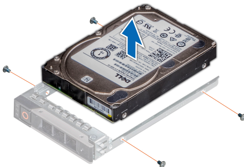
図 32. ドライブ キャリアからのドライブの取り外し
