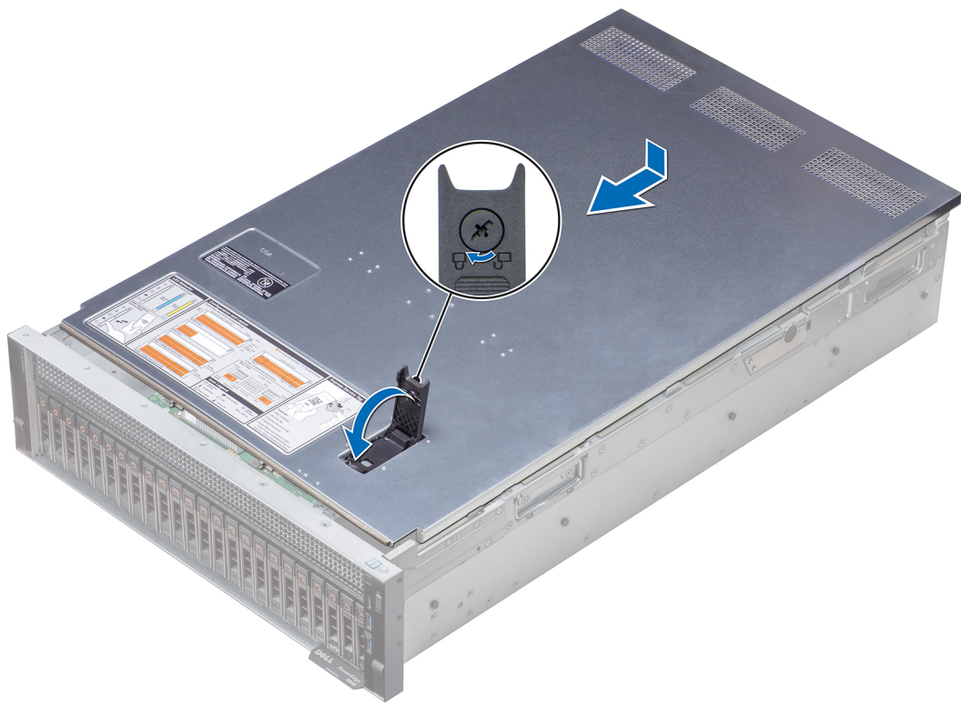
図 16. システムカバーの取り付け
