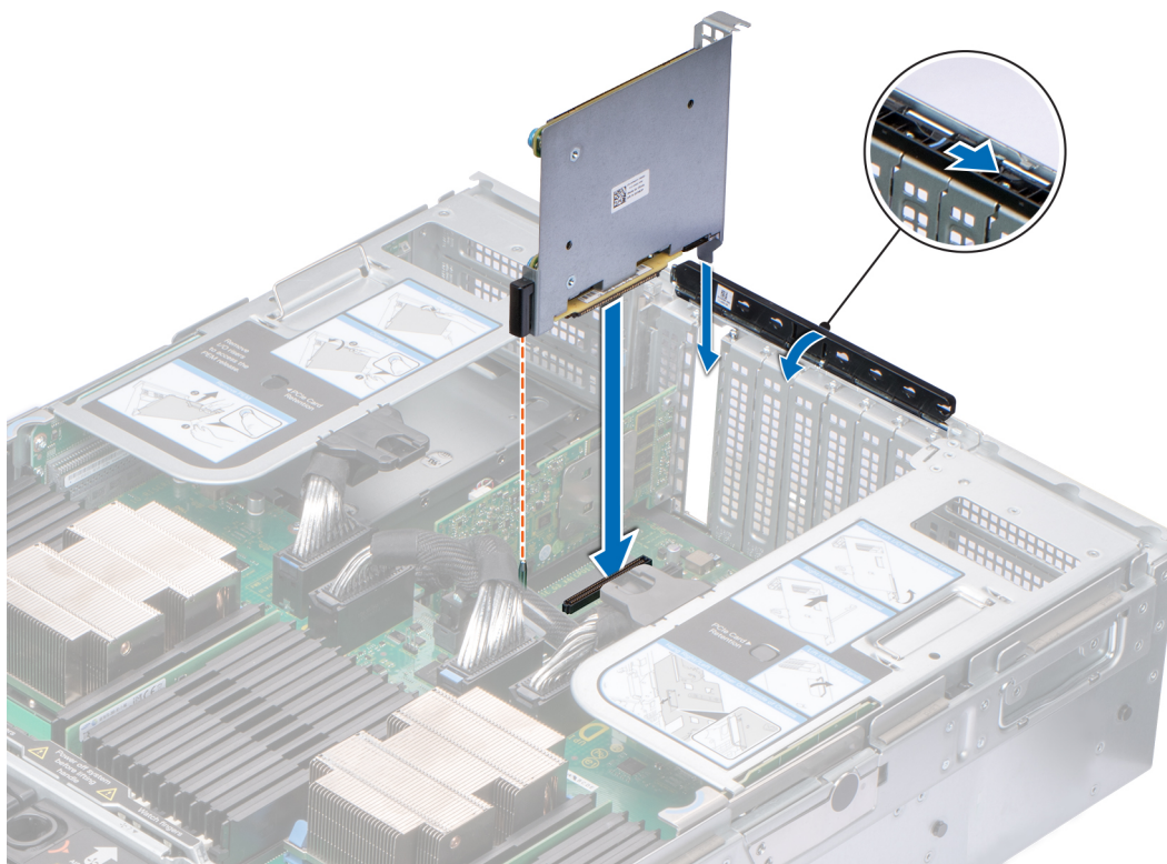
図 45. NDC ライザーの取り付け
