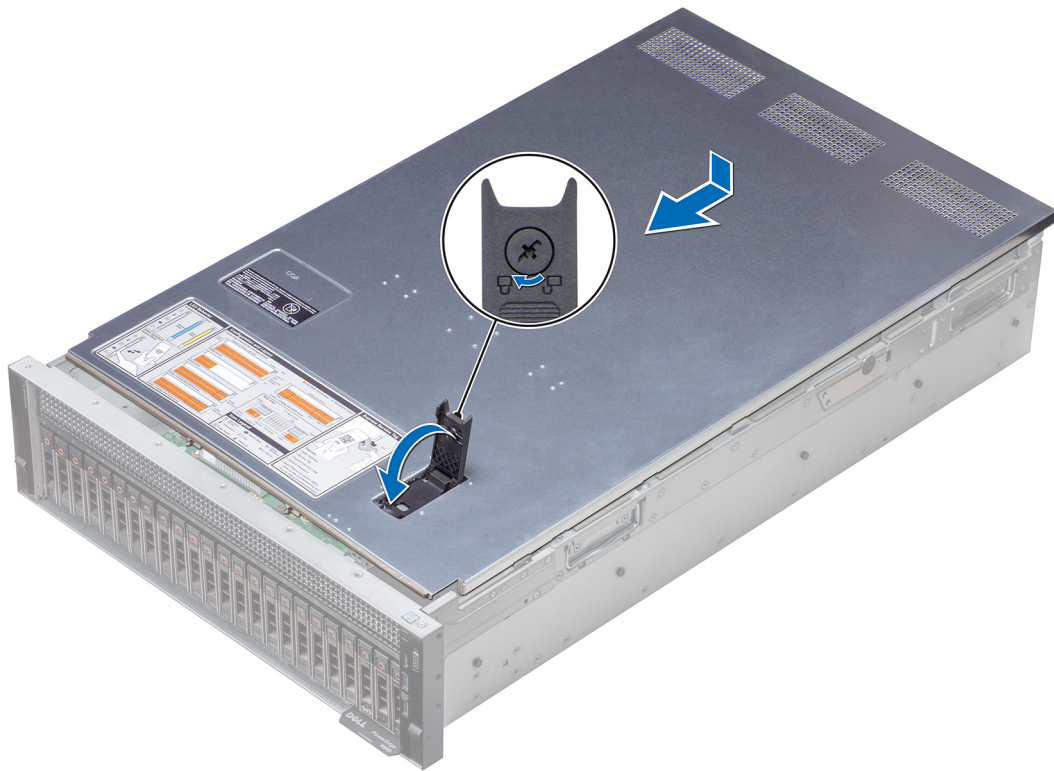
Figura 16. Instalación de la cubierta del sistema
