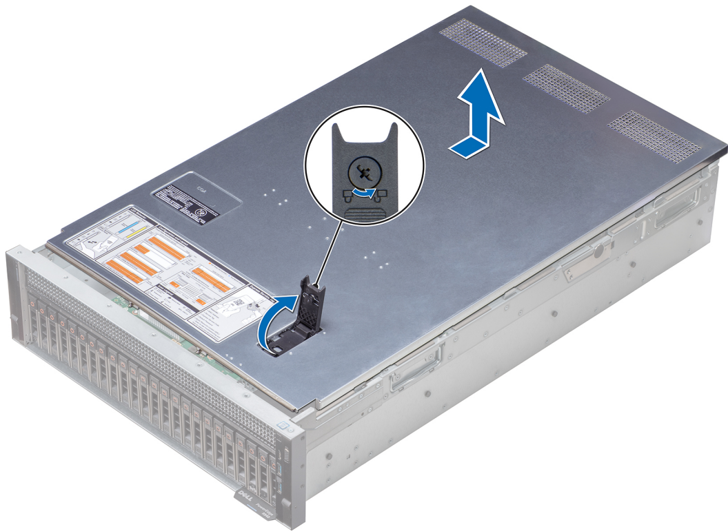
Figura 15. Extracción de la cubierta del sistema
