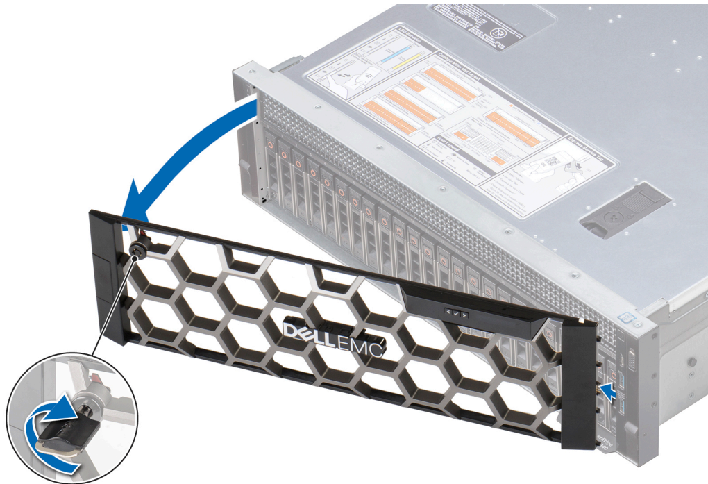
Figura 13. Extracción del bisel frontal opcional con el panel LCD
