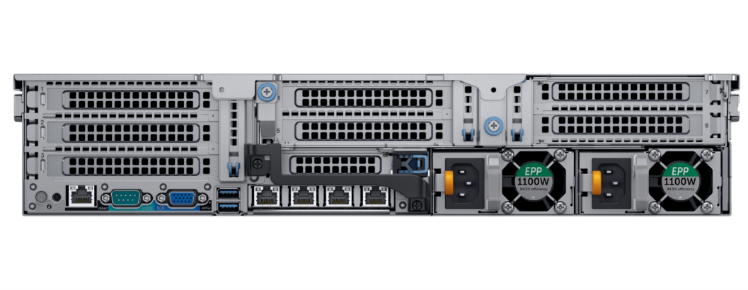
図 3. 2.5 インチ ハードドライブ 4 台構成の背面図
