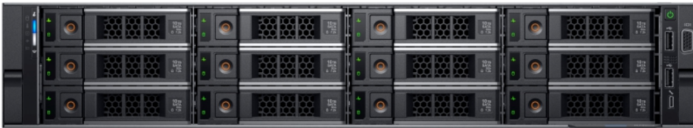
Figure 1. Vue avant d'une configuration à 12 disques durs de 3,5 pouces
