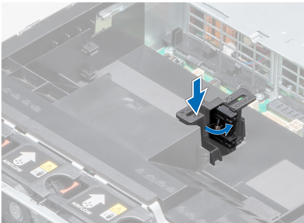
图 48: 打开 PCIe 卡固定器门锁
