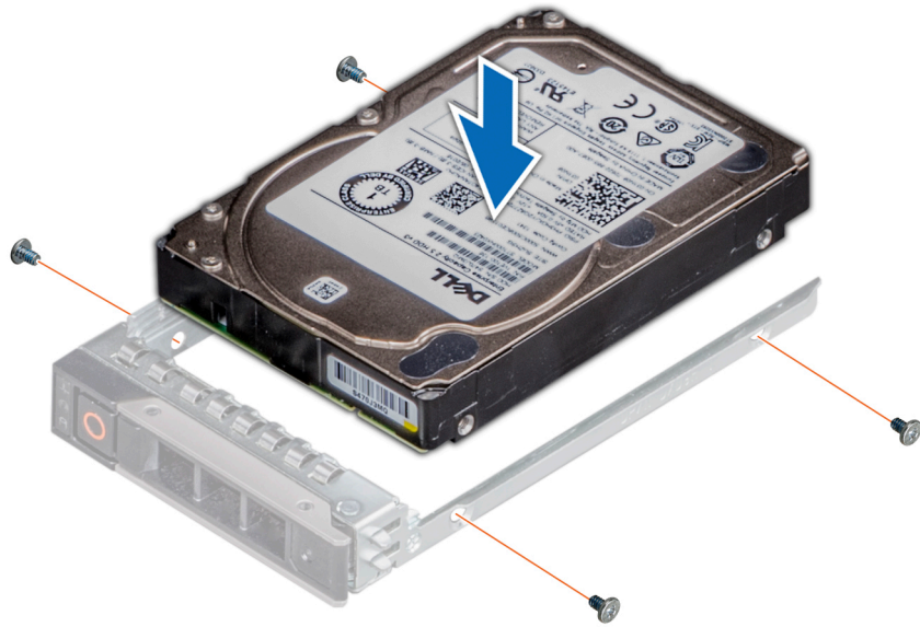
图 35: 将硬盘驱动器安装到硬盘驱动器托盘中
