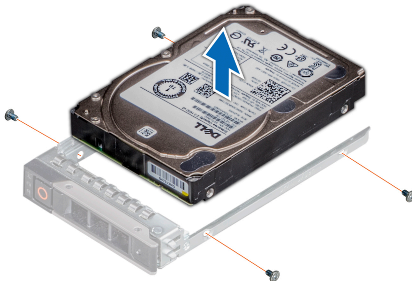
図 34. ハードドライブキャリアからのハードドライブの取り外し
