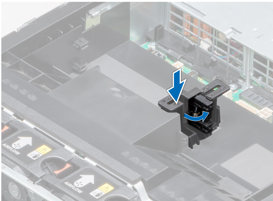
図 48. PCIe カードホルダラッチを開く
