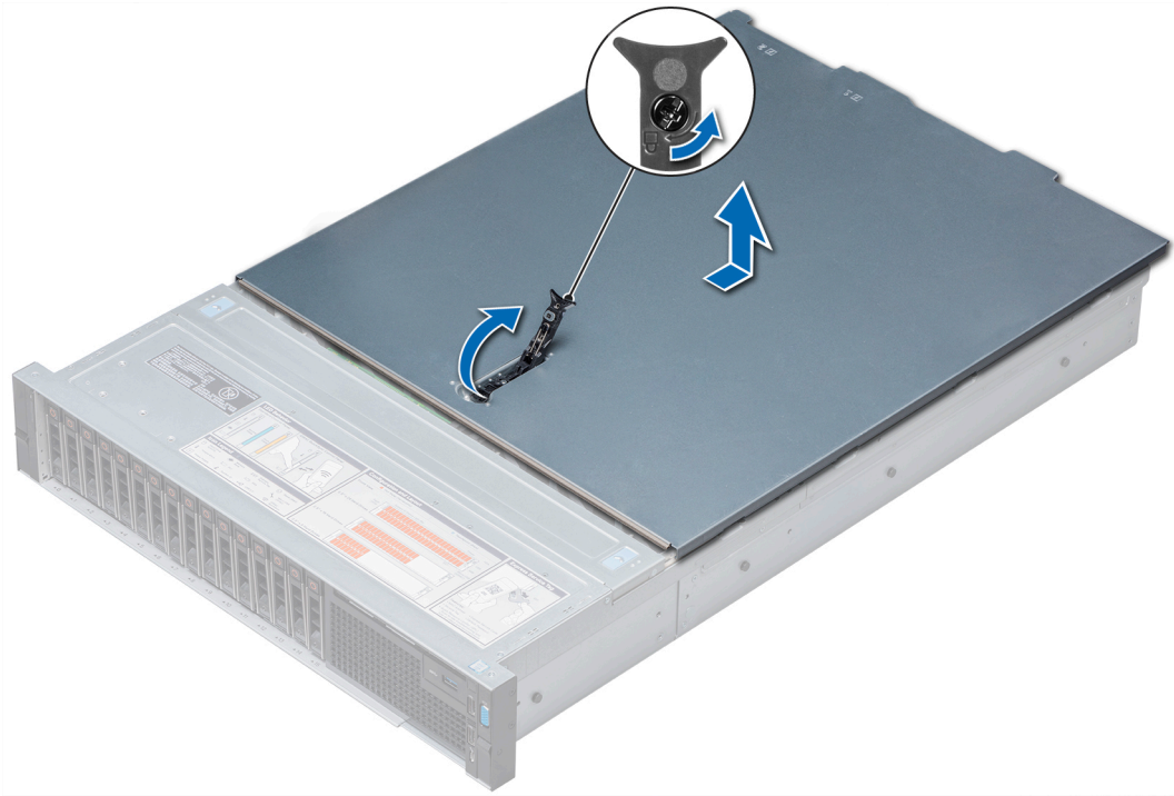
図 17. システムカバーの取り外し
