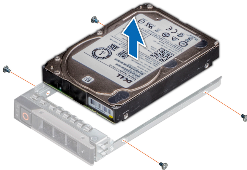
Figura 34. Extracción de la unidad de disco duro del portaunderes de disco duro
