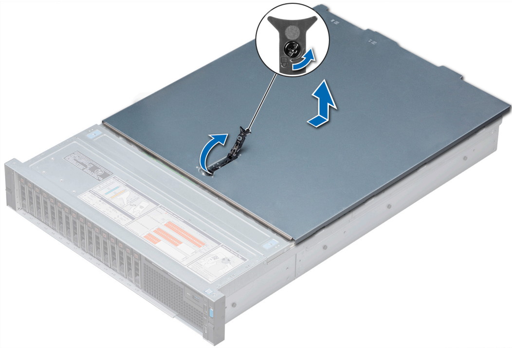
Figura 17. Extracción de la cubierta del system
