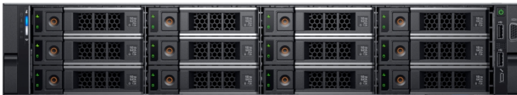
Abbildung 1. Vorderansicht des Systems mit 12 x 3,5-Zoll-Festplatten
