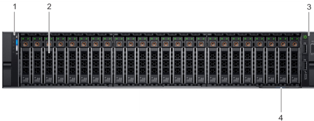
Abbildung 2. Vorderansicht des Systems mit 24 x 2,5-Zoll-Festplatten
