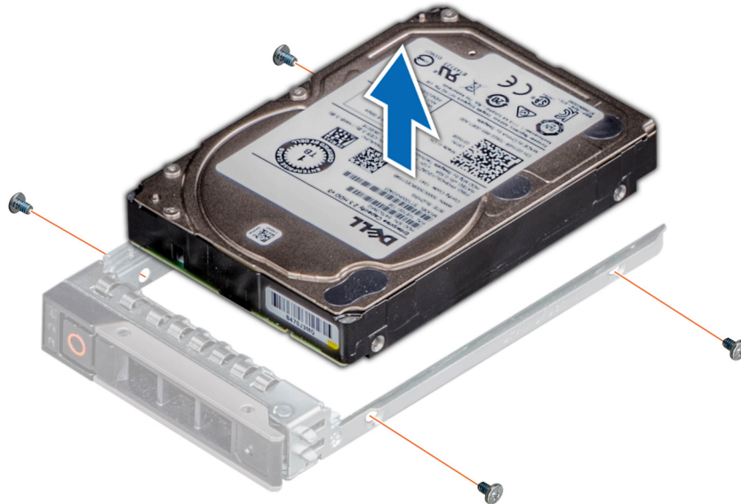
Abbildung 34. Entfernen der Festplatte aus dem Festplattenträger
