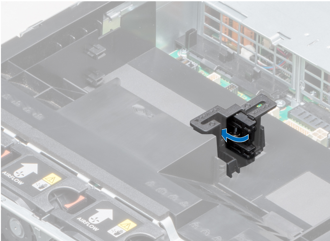
Abbildung 49. Schließen der PCIe-Kartenhalterverriegelung
