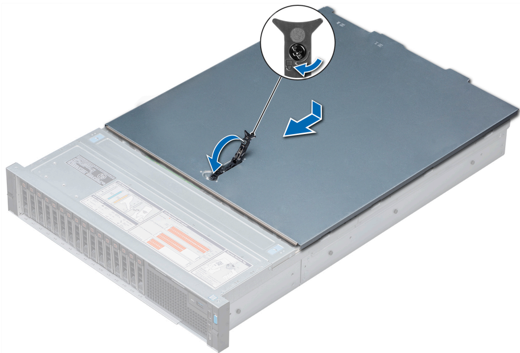
Abbildung 18. Installieren der Systemabdeckung
