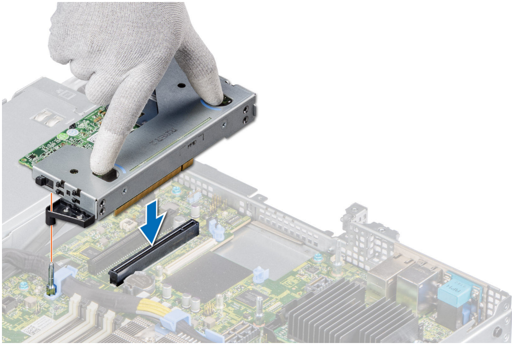
图 50: 安装薄型左侧提升板
