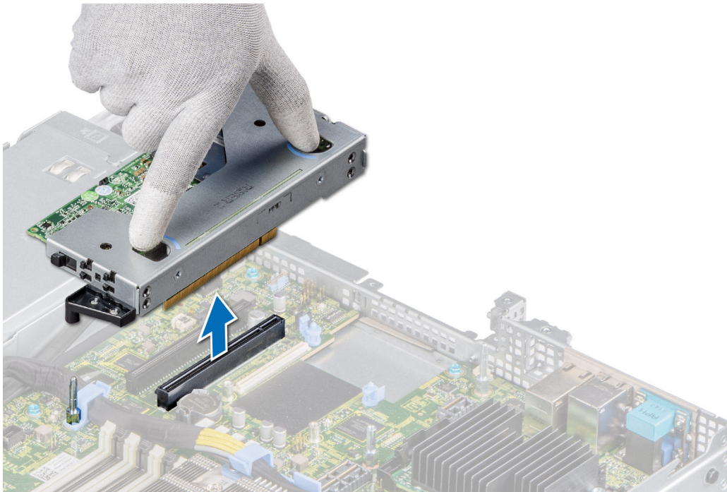
图 48: 卸下薄型左侧提升板
