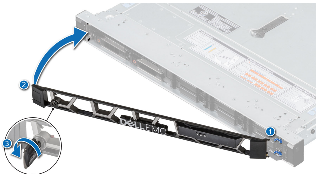
图 15: 安装带 LCD 面板的前挡板
