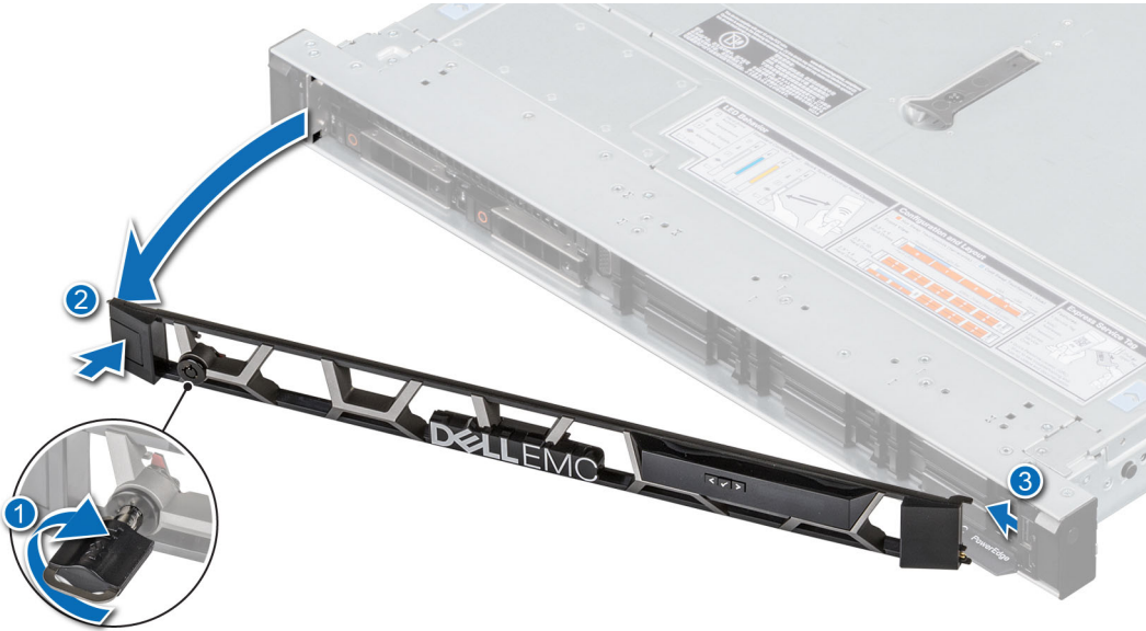
Rakam 14. LCD panelli ön çerçeveyi çıkarma
