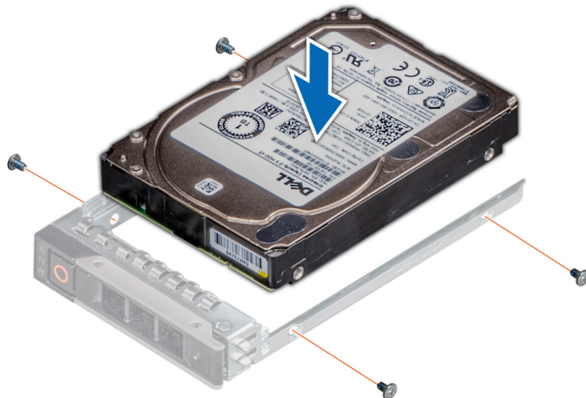
図 31. ドライブ キャリアーへのドライブの取り付け
