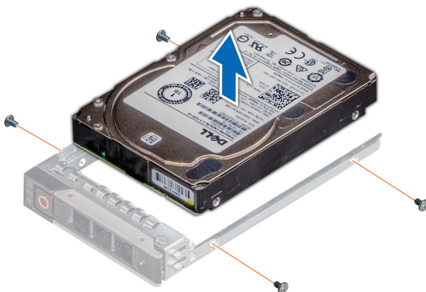
図 30. ドライブ キャリアからのドライブの取り外し
