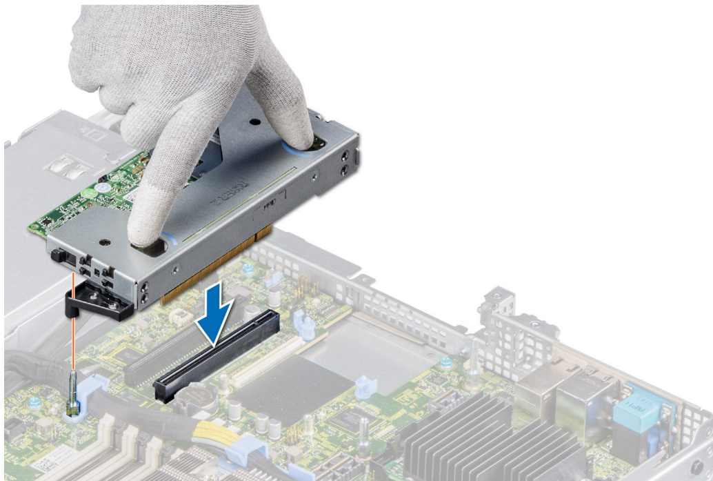
図 50. 左の薄型ライザーの取り付け
