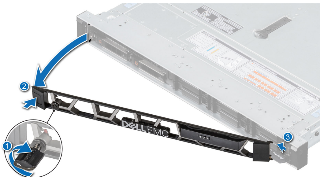
図 14. LCD パネルを含む前面ベゼルの取り外し
