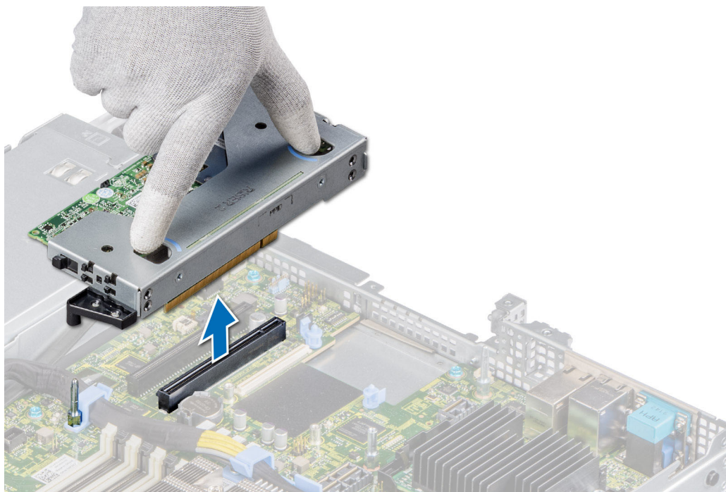
図 48. 左の薄型ライザーの取り外し
