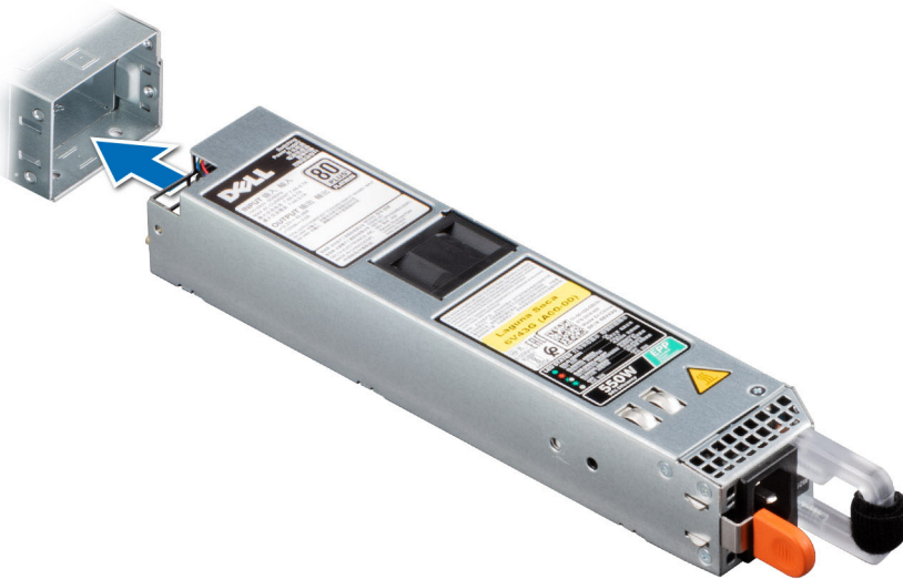
Figure 85. Installation d'un bloc d'alimentation
