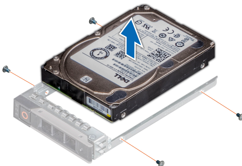
Figure 30. Retrait d'un disque installé dans un support de disque
