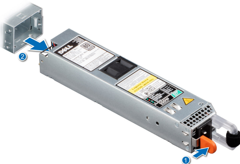
Figure 84. Retrait d'un bloc d'alimentation
