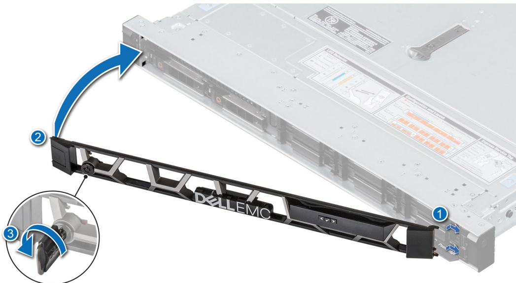
Figure 15. Installation du panneau avant avec l'écran LCD
