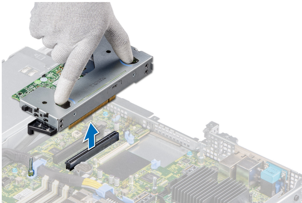
Figure 48. Retrait de la carte de montage compacte gauche
