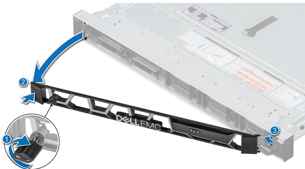
Figure 14. Retrait du panneau avant avec l'écran LCD
