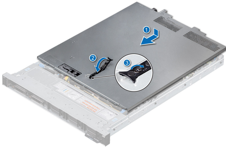
Ilustración 17. Instalación de la cubierta del sistema
