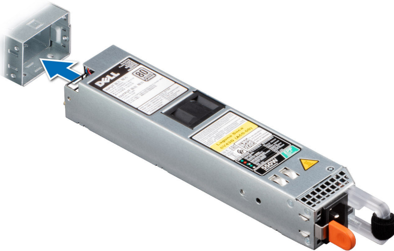
Ilustración 85. Instalación de una fuente de alimentación
