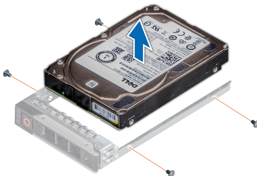
Ilustración 30. Extracción de la unidad del portaunidades
