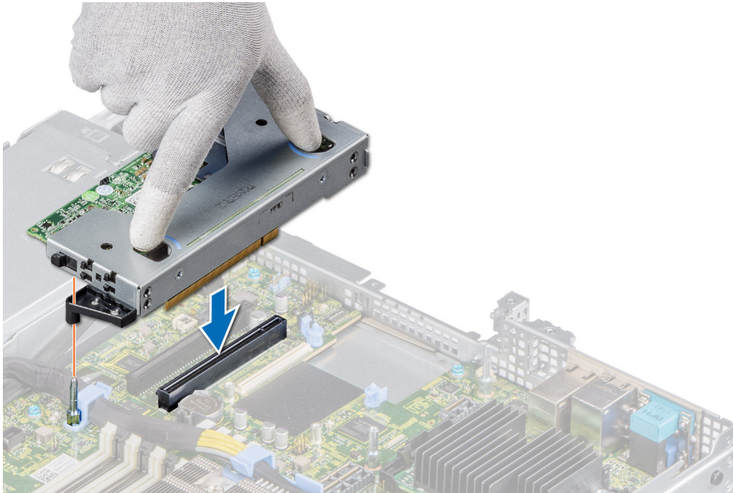
Ilustración 50. Instalación del soporte vertical de perfil bajo izquierdo
