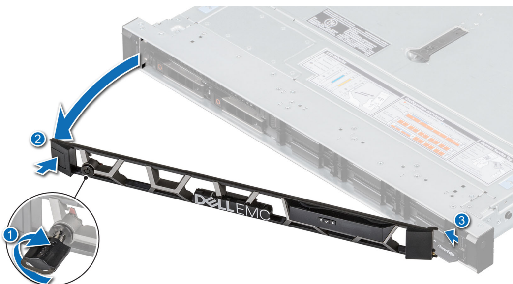
Ilustración 14. Extracción del bisel frontal con el panel LCD
