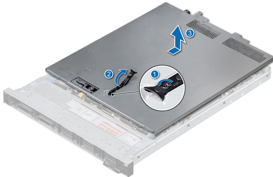
Ilustración 16. Extracción de la cubierta del sistema
