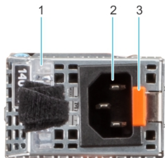
Ilustración 104. Indicador de estado de la unidad de fuente de alimentación de CA
