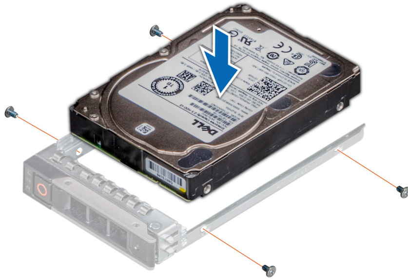
그림 58. 하드 드라이브 캐리어에 하드 드라이브 설치
