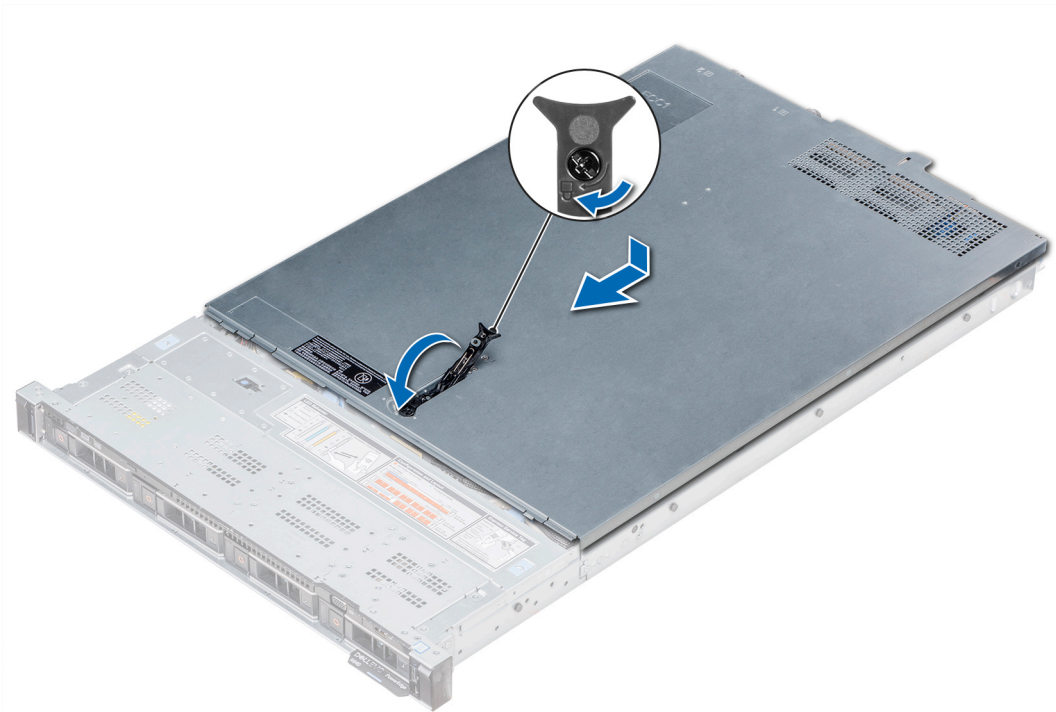
그림 17. 시스템 덮개 장착
