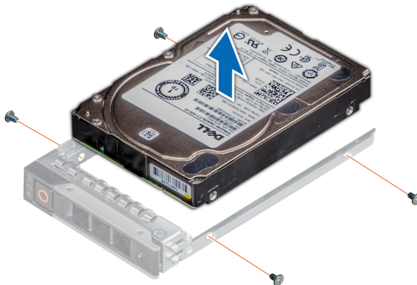
図 57. ハードドライブキャリアからのハードドライブの取り外し
