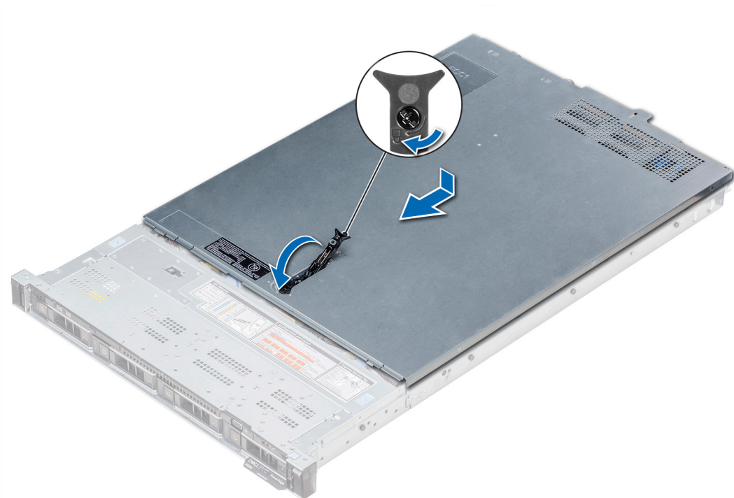
Figure 17. Installation du capot du système
