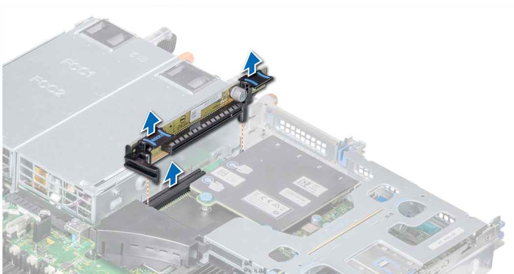
Figure 36. Retrait de la carte de montage 2A pour carte d'extension
