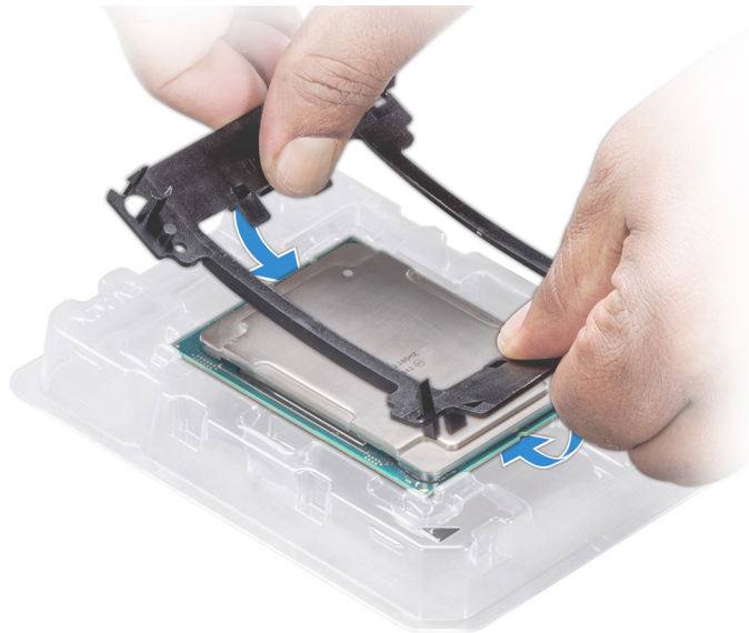
Figura 31. Instalación del soporte del procesador
