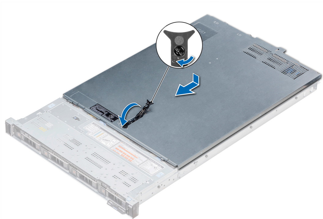
Abbildung 17. Installieren der Systemabdeckung
