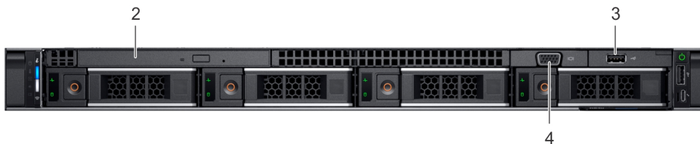
Abbildung 2. Vorderansicht des 4-x-3,5-Zoll-Laufwerks-Systems
