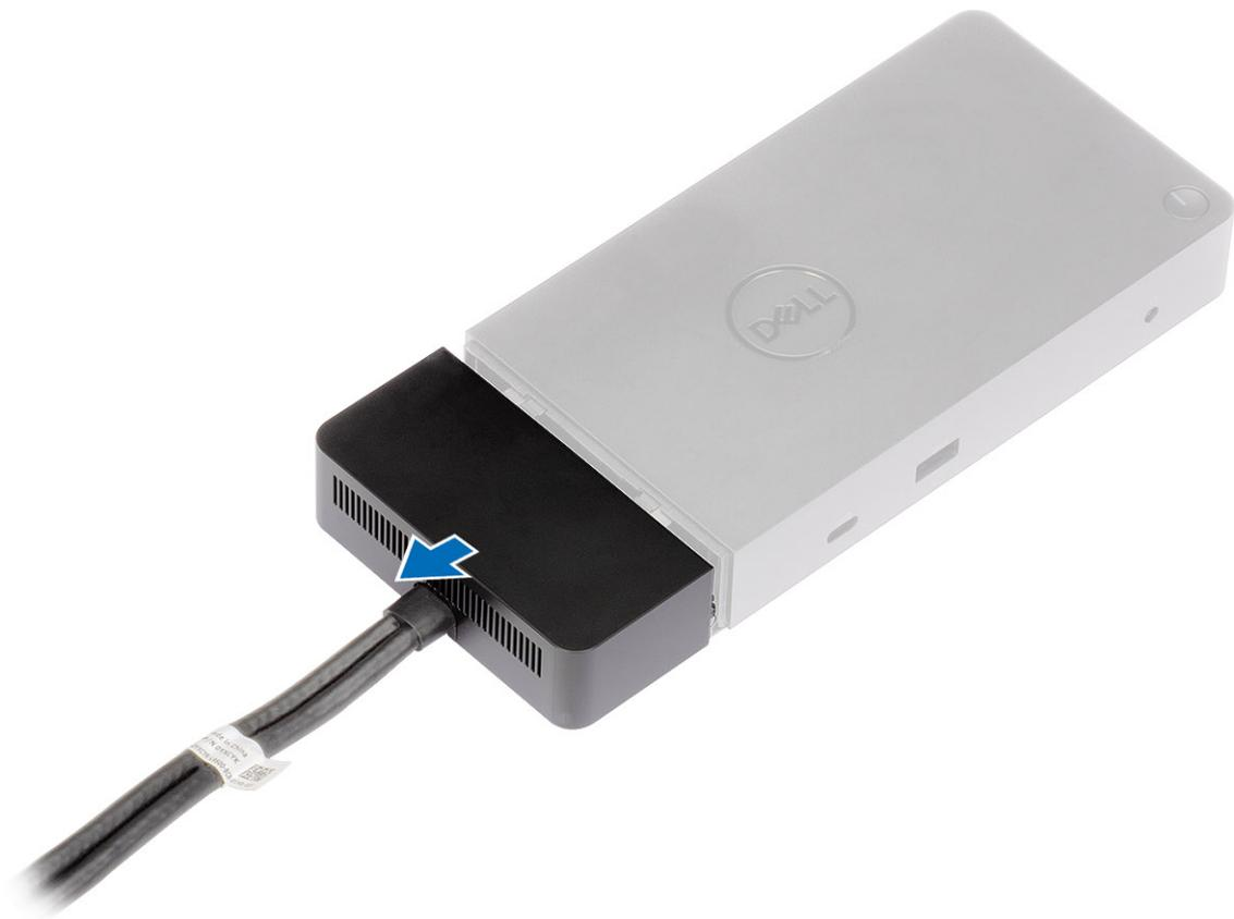
4. 从坞站中的连接器轻轻提起并卸下 USB Type-C 电缆模块。
