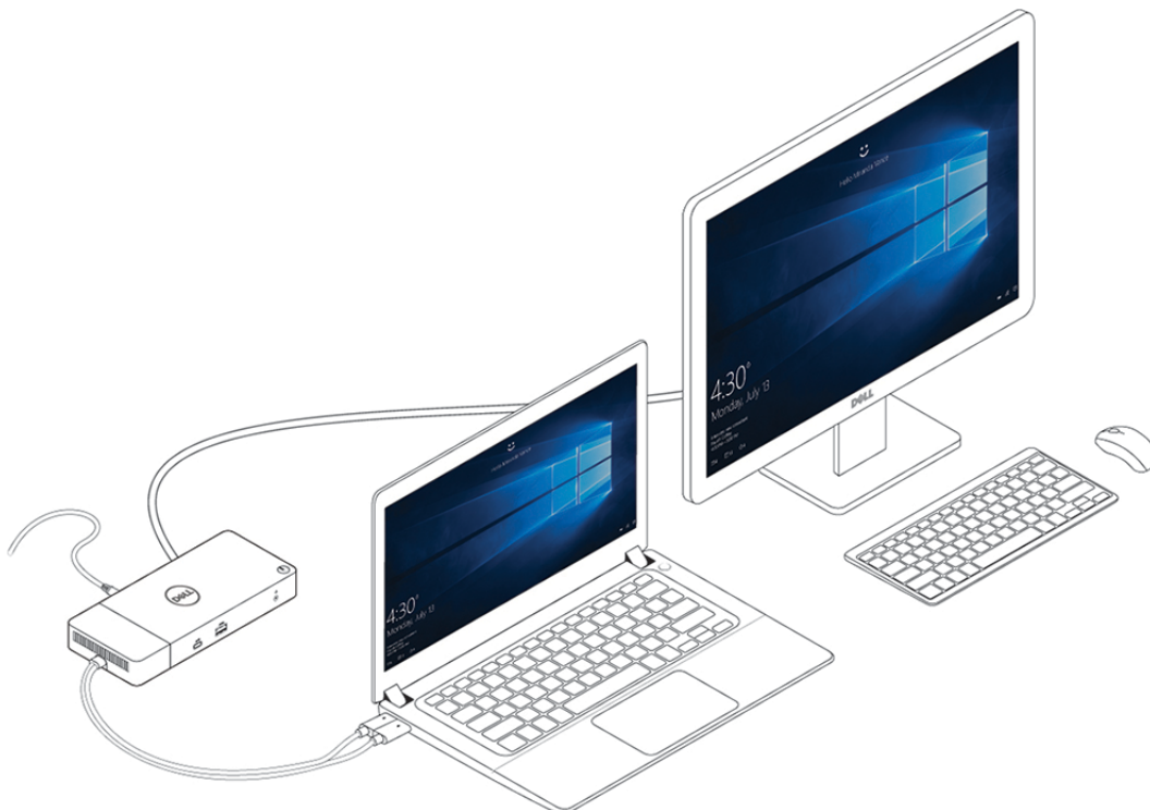
Ilustración 8. Conexión de varias pantallas
