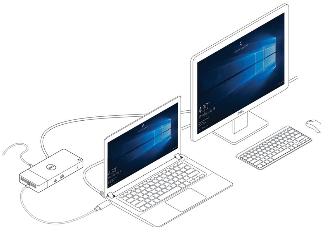
Rysunek 8. Podłączenie wielu monitorów
