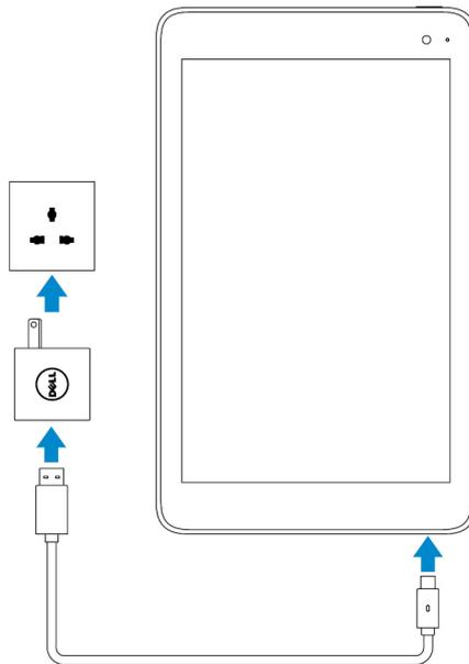
**N.B.:** Una batteria completamente scarica richiede circa 4 a 5 ore per una carica completa.
