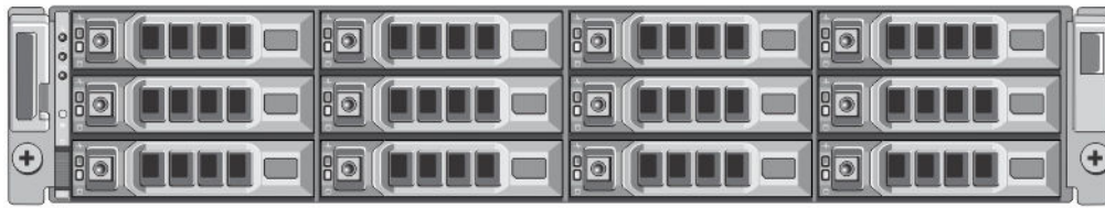
Ilustración 2. Ubicaciones de las ranuras de unidad (MD1200) del estante de expansión del sistema DR Series
