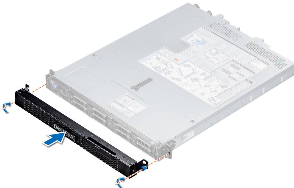
図 18. 前面ベゼルの取り付け
