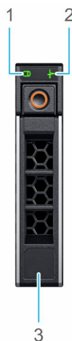
Figure 6. Voyants situés sur le disque et le fond de panier du plateau de disques intermédiaires
