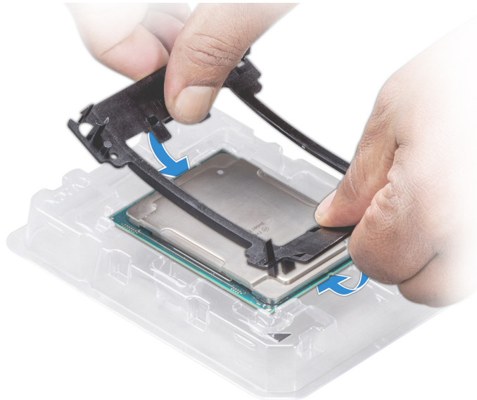
Figure 53. Installation du support de processeur
