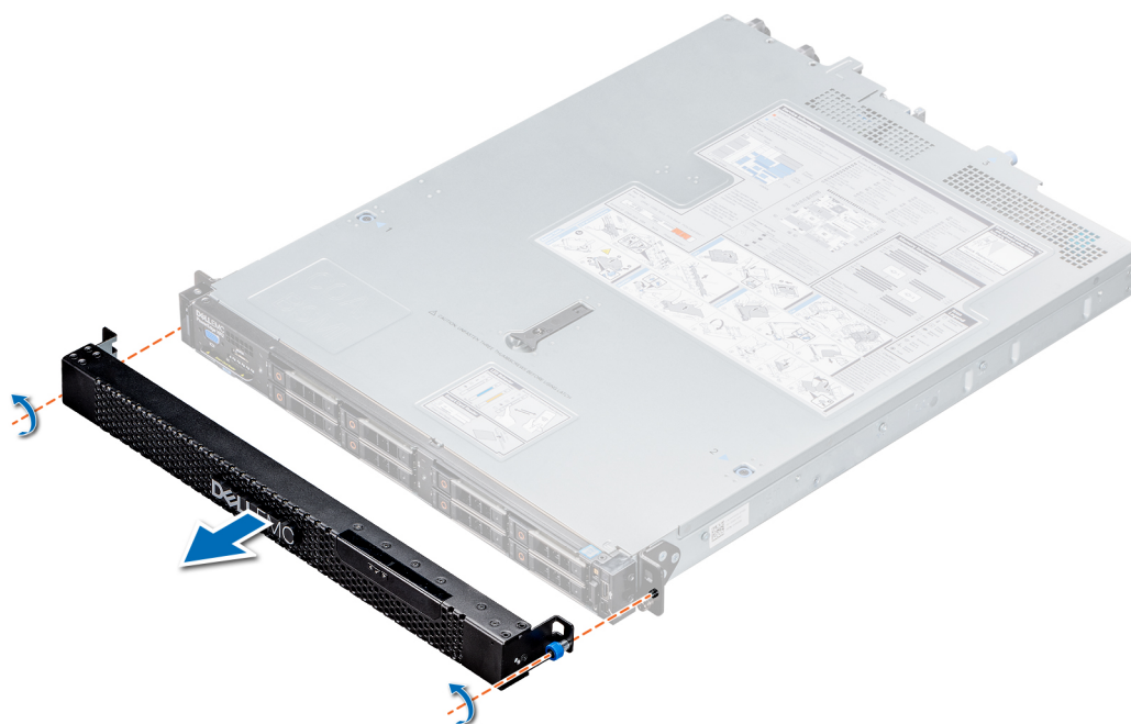
Ilustración 17. Extracción del bisel frontal
