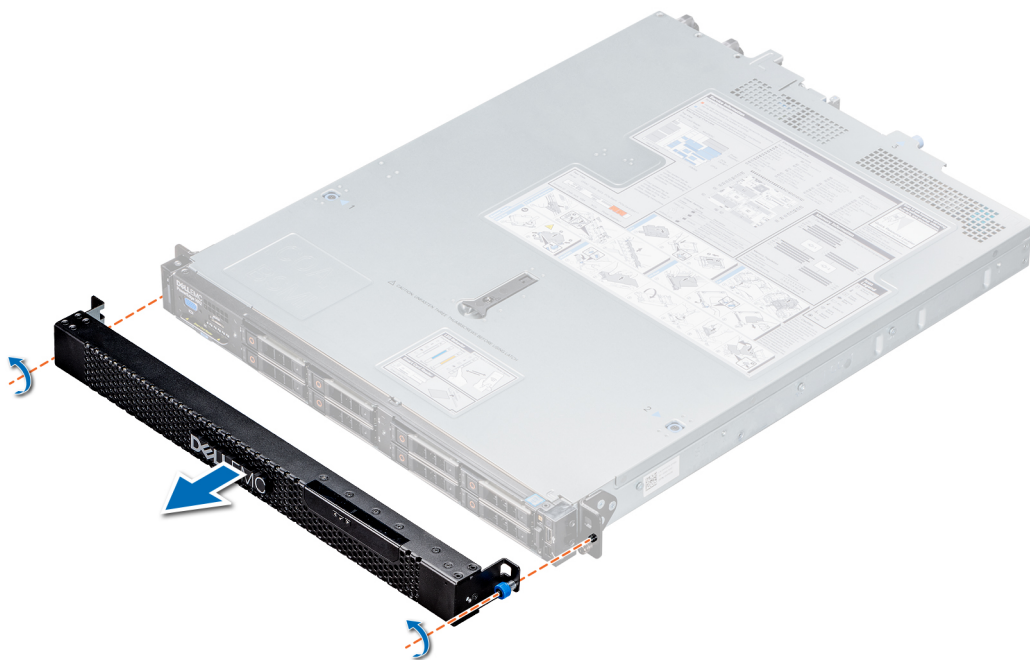
Abbildung 17. Entfernen der Frontverkleidung
