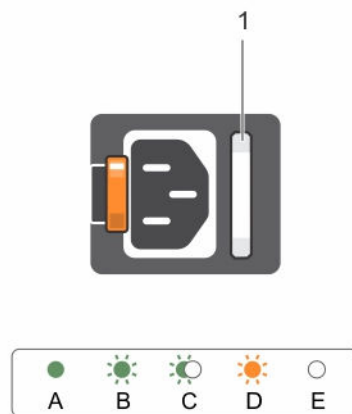
Ilustración 9. Indicador de estado de la unidad de fuente de alimentación de CA
