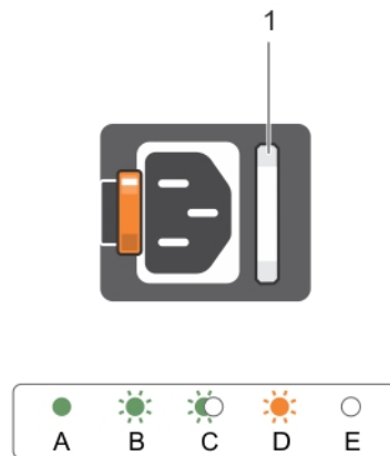
Abbildung 9. Statusanzeige des Wechselstrom-Netzteils
