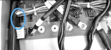
Rakam 134. PDB'ye giden güç kablosunun (BP-PDB) montajı
