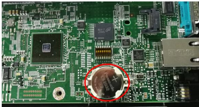
Ilustración 87. Localice la batería en la placa del servidor
