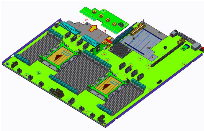
Ilustración 84. Extracción de la placa mediadora de alimentación
