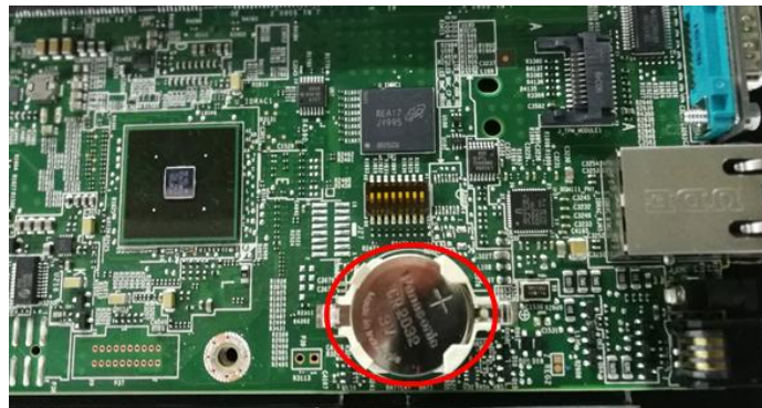
Abbildung 87. Batterie auf der Serverplatine suchen
