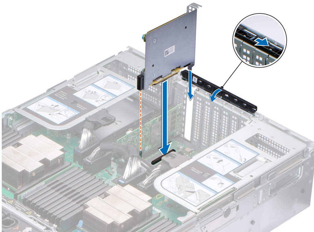
图 45: 安装 NDC 提升板
