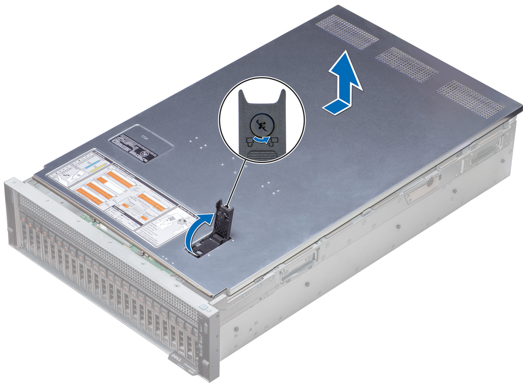
Figura 15. Extracción de la cubierta del sistema
