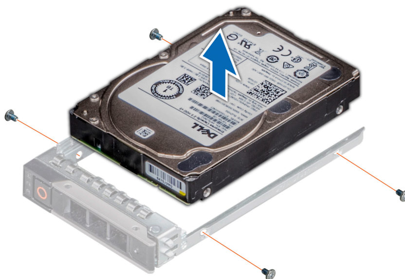
Figura 32. Extracción de la unidad del portaunidades
