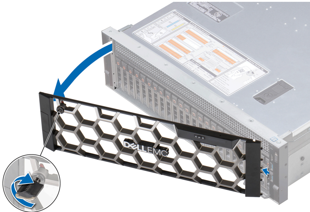
Abbildung 13. Entfernen der optionalen Frontverkleidung mit LCD-Display
