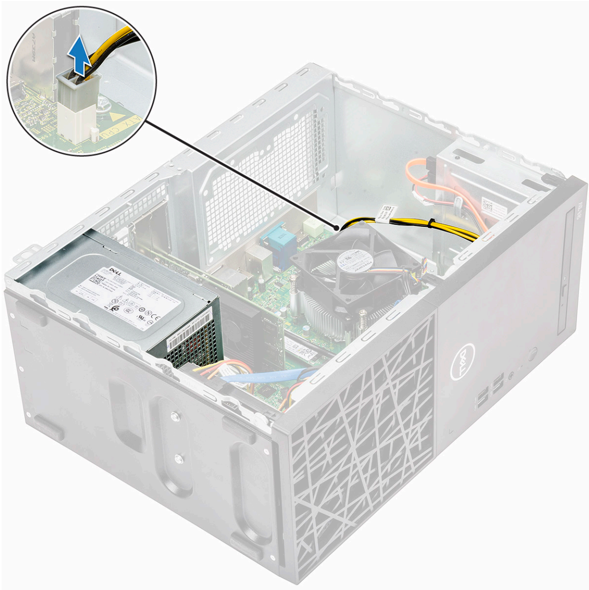
b 从金属和塑料固定夹释放缆线 [1、2、3]。
