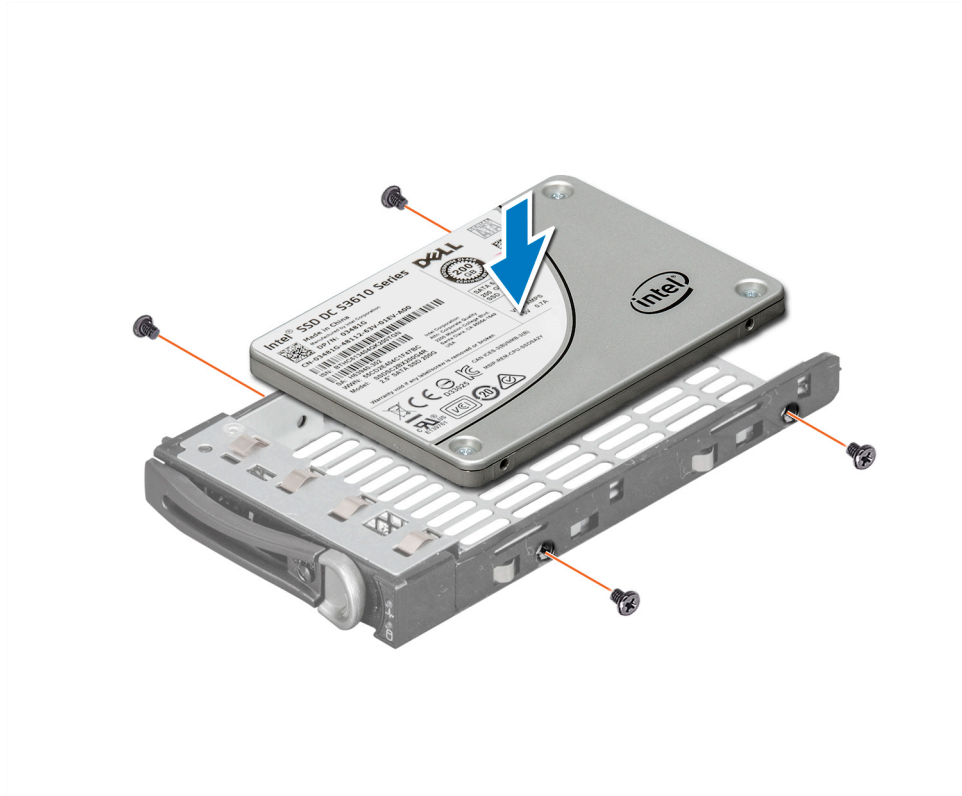
그림 28. 하드 드라이브 캐리어에 하드 드라이브 설치
