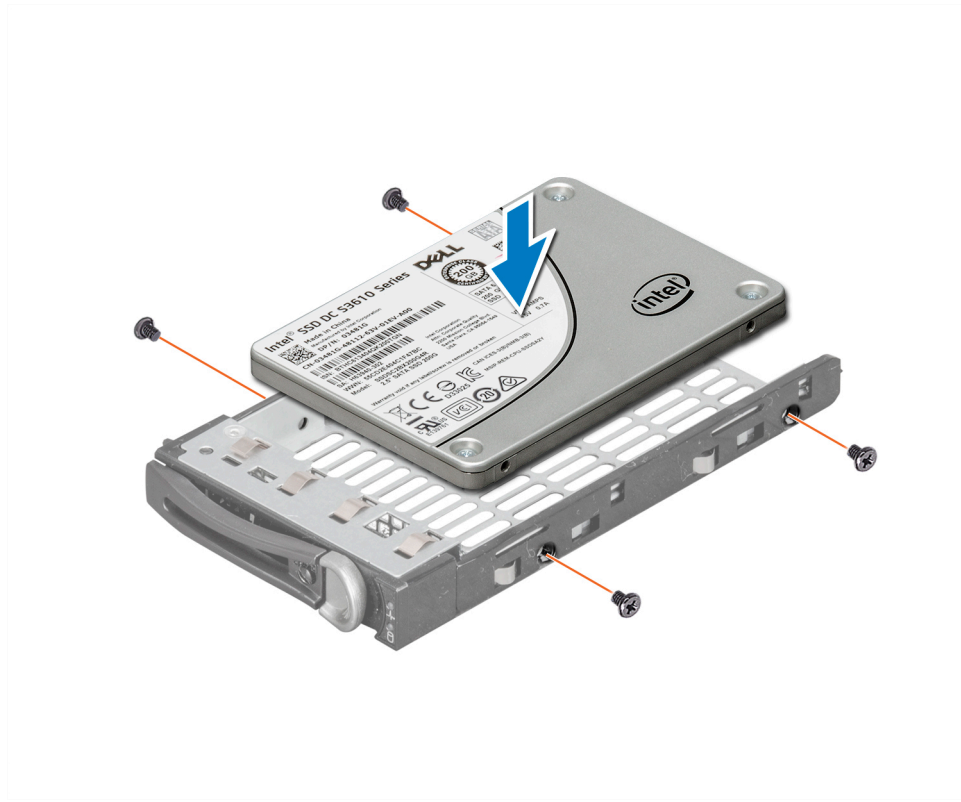
Ilustración 28. Instalación de una unidad de disco duro en un portaunidades de disco duro
