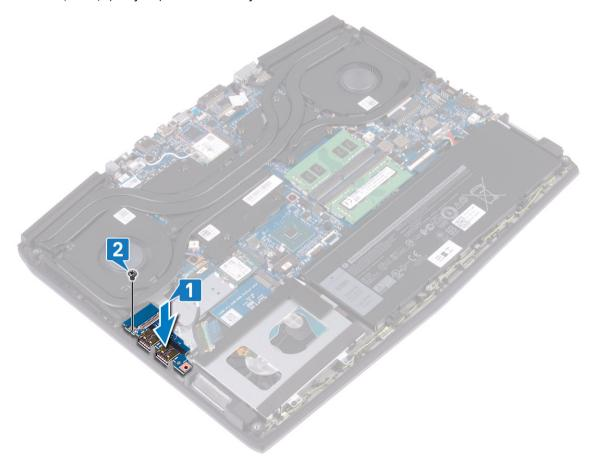
Conecte el cable de la placa de E/S al conector de la placa de E/S y cierre el pestillo para fijarlo.
