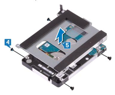
6 Desconecte la unidad mediadora del ensamblaje de la unidad de disco duro.
