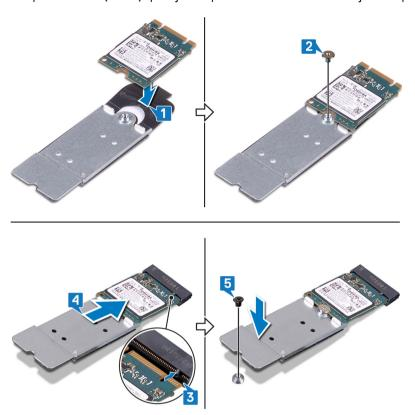
6 Alinee los orificios para tornillos del blindaje térmico M.2 con los orificios para tornillos en el ensamblaje del reposamanos y la tarjeta madre del sistema.
