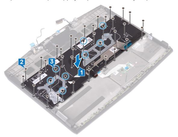
NOTA: El teclado se envía con una cinta de mylar, que se debe adherir al soporte del teclado después de reemplazar los tornillos. La cinta de mylar tiene tres capas: papel transparente, cinta de mylar negra y cinta de mylar azul.
