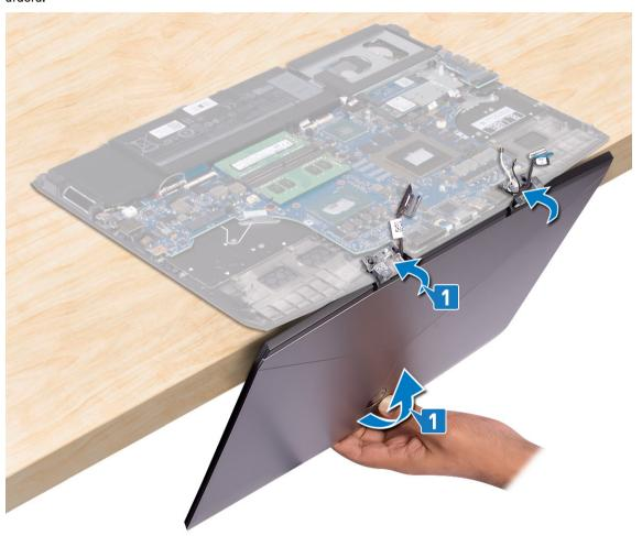
2 Reemplace los dos tornillos (M2.5x2.5) que fijan las bisagras al ensamblaje del reposamanos.
