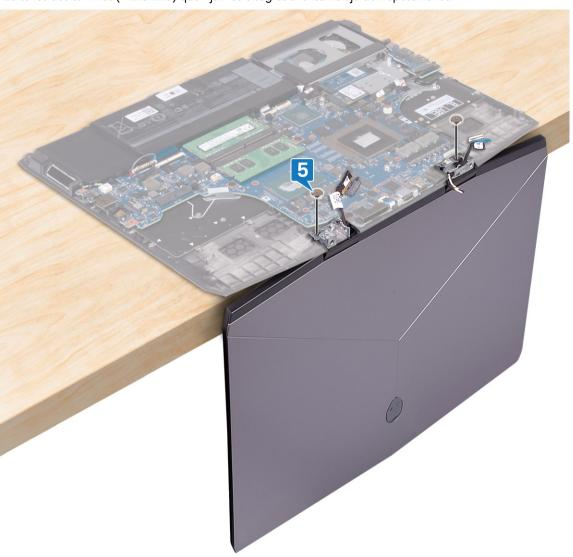
6 Gire el ensamblaje de la pantalla hacia adentro y, a continuación, levántelo y quítelo del ensamblaje del reposamanos.
