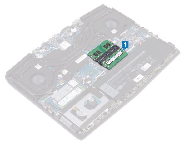
Abra con cuidado con la punta de los dedos los ganchos de fijación situados en los extremos de la ranura del módulo de memoria hasta que salga el módulo de memoria.
