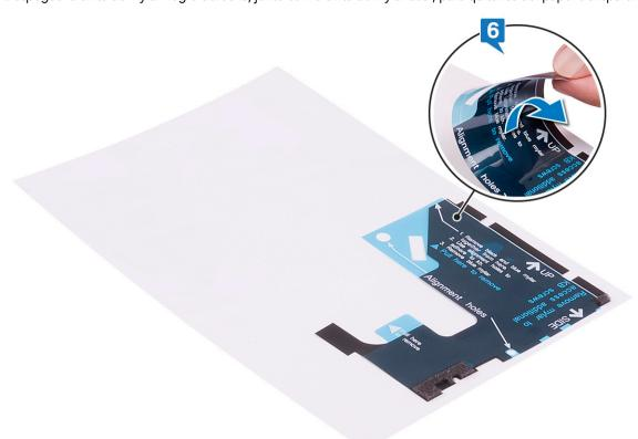
7 Mediante los orificios de alineación, adhiera la cinta de mylar del teclado en el lateral derecho del soporte del teclado.
