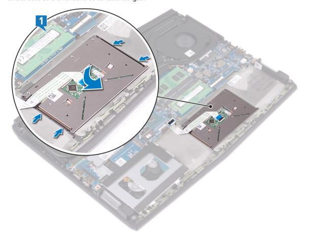
Reemplace los cuatro tornillos (M2x2.5) que fijan la almohadilla de contacto al ensamblaje del reposamanos.
