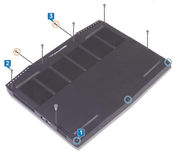
4 Mediante un instrumento de plástico acabado en punta, haga palanca para quitar la cubierta de la base de la computadora.
