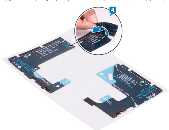
5 Mediante los orificios de alineación, adhiera la cinta de mylar del teclado en el lateral izquierdo del soporte del teclado.
