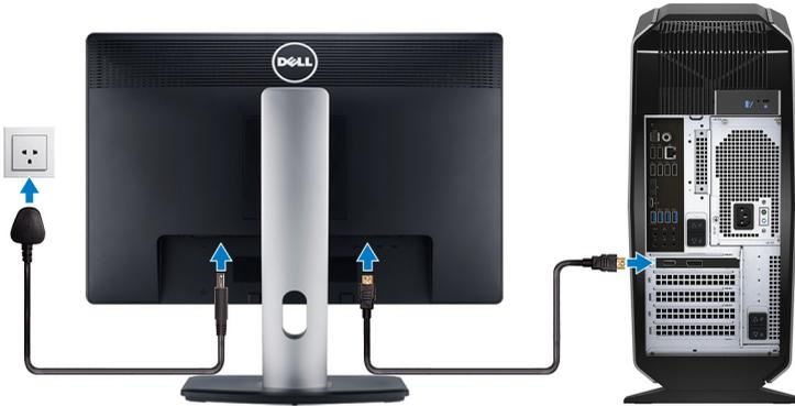
**NOTA:** El DisplayPort en el panel posterior del equipo está cubierto. Conecte la pantalla a la tarjeta de gráficos discretos del equipo.
